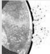
Los contaminantes hacen que los recubrimientos se deterioren, dejando microcavidades en la superficie del rotor.
