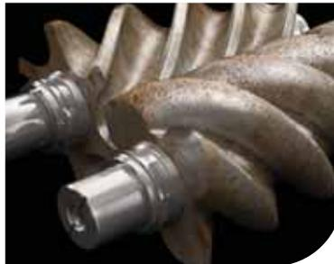
Schraubenkompressoren mit konventionellem Schmiermittel
