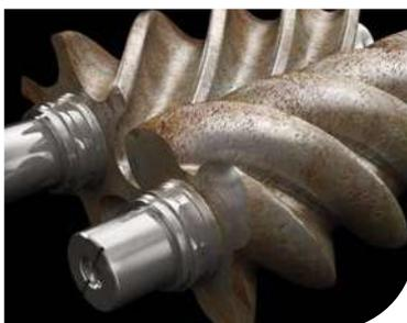
Rotors avec lubrifiant traditionnel
